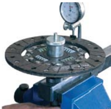
Enne siduriketast paigaldamist tuleb külgväljajooksu kontrollida ja vajadusel korrigeerida
