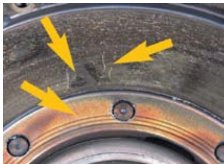
Sekundaarse hooratta ülekuumenemine
