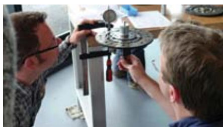
Töökoja töötajate jaoks ei ole külgväljajooksu testimine aeganõudev
