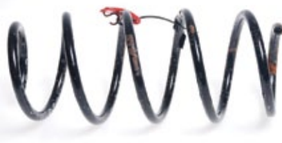
Joonis 3. Vedru pinnadefektid pärast 1000 tundi soolveekatset
