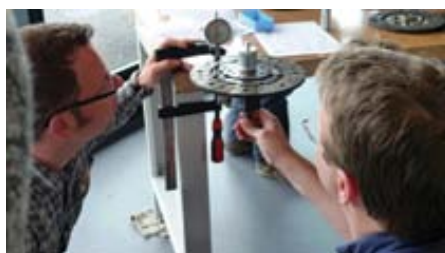
3. att. Darbnīcā strādājošajam sānu nolietojuma pārbaude neaizņem daudz laika
