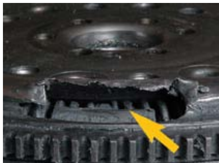
2. att. Ir nodilis primārais spararats
