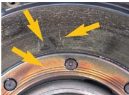
1. att. Sekundārā spararata pārkaršana
