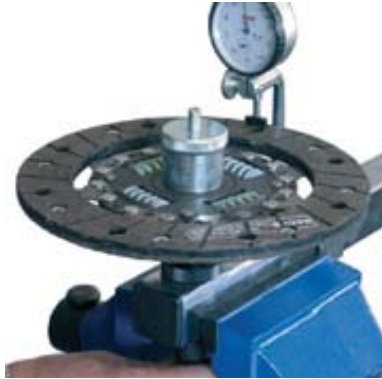
2 pav. Prieš montuojant sankabos diską, visada būtina išmatuoti skersinį judėjimą
