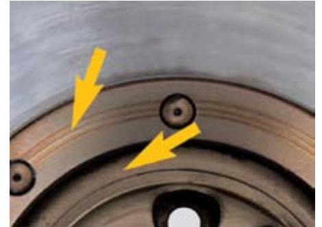
3 pav. Antrinio smagračio vidinės pusės perkaitimo požymiai
