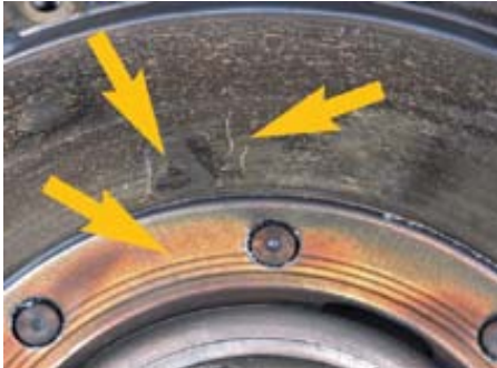
1 pav. Antrinio smagračio perkaitimas
