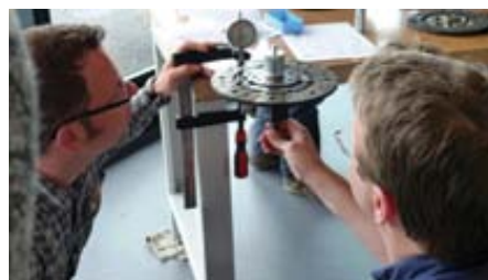
3 pav. Autoserviso personalui skersinio judėjimo testavimas daug laiko neatims
