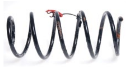
3. att. Atsperes virsmas defekti pēc 1000 stundu ilgas testēšanas ar sāls izsmidzināšanas metodi.
