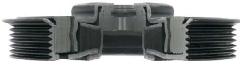
Zīm.2. Vērpes svārstību kloķvārpstas skriemelis ar aizbīdni.
