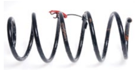
3 pav. Spyruoklės paviršiaus defektai po 1000 valandų druskos purškimo testo
