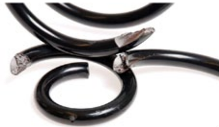
2 pav. Pigesnių spyruoklių gyvavimo ciklo testo rezultatai
